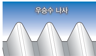
축을 기준으로 나사산이 오른쪽으로 올라가는 나사. 특별한 경우를 제외하고는 주로 우승수 나사를 사용
